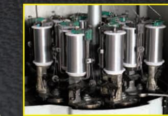
Schermo speciale ad alta resistenza, realizzato con lega resistente in alluminio-magnesio (AlMg). La trecciatura è operata tramite macchine 16 spole, MOLTO EFFICACE CONTRO I DISTURBI IMPULSIVI.
